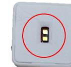
Il sensore PDM funziona come un puntatore laser: misura la distanza a seconda della direzione in cui viene rivolto.
