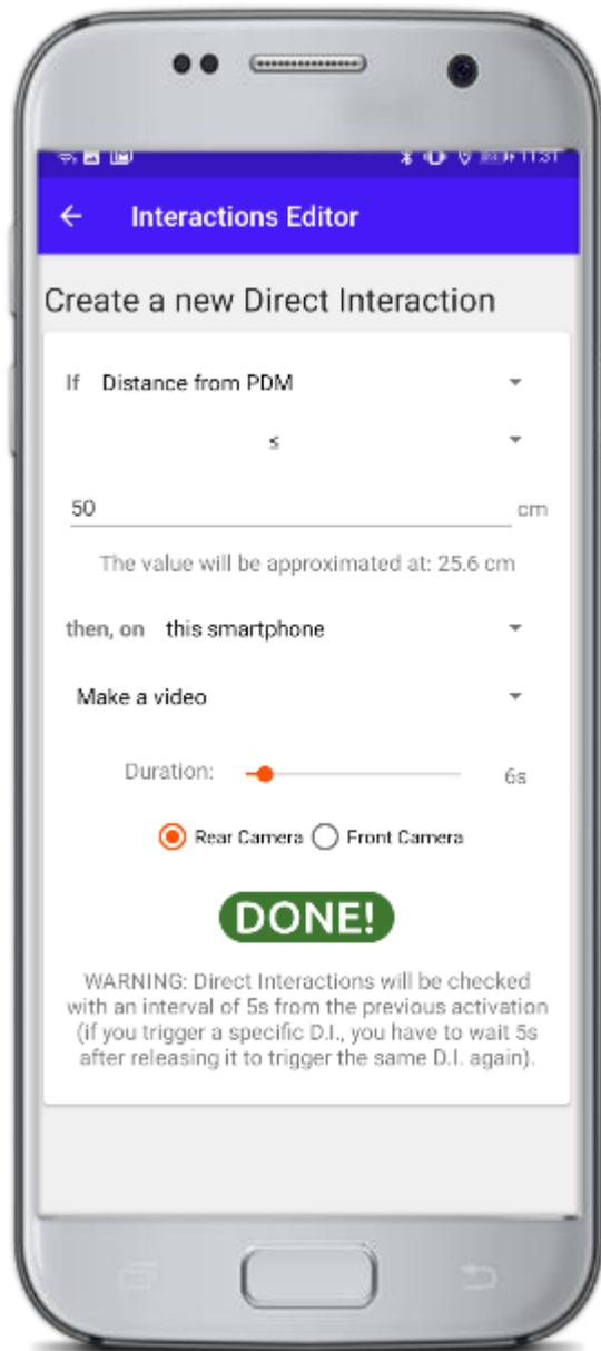
Se la distanza misurata dal PDM è minore o uguale a 50 cm (ossia se viene rilevata una presenza) allora lo smartphone fa un video di 6 secondi.
