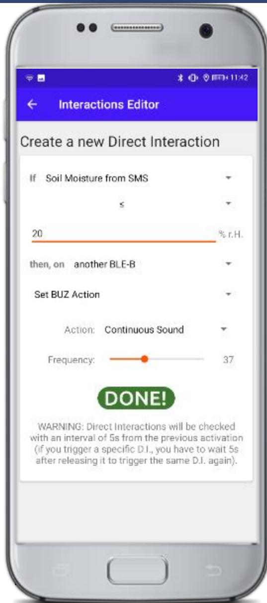
Se l'umidità del terreno della pianta è inferiore o uguale a 20% r.H. (misurato dal BLE-B con l'SMS) allora il BLE-B con il BUZ emette un suono continuo.
